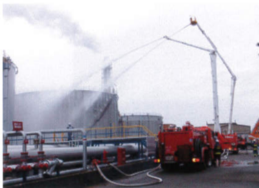
高所保水車による放水
